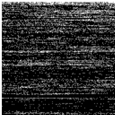
FIG. 3.17 – Détection au compteur de photons du passage des molécules de Rh6G en solution dans l'éthanol dans le volume sondé. La position du laser est fixée. L'"image" totale présentée comporte 128 \times 128 pixels dont l'intensité correspond au nombre de coups détectés en 1ms. L'analyse de cette "image" permet d'évaluer le taux présence des molécules dans le volume sondé.
