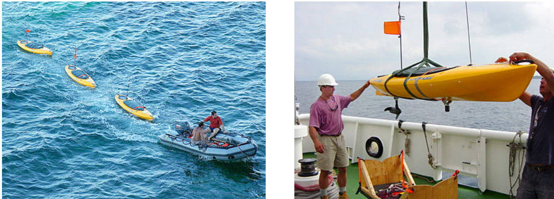
FIGURE 2.6 – SCOUT : trois plates-formes en coopération (a) et avec des AUV sur le pont d'un navire lors d'une campagne de test de coopération ASV-AUV (MIT, États-Unis)
